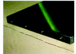
材質：DC53 t30×350角 幅350にワイヤーカット加工
